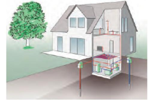
**Grundwasser** ist ein sehr guter Wärmespeicher mit ganzjährig relativ konstanten Temperaturen. Selbst an kalten Wintertagen besitzt das Wasser noch eine Temperatur von 7 bis 12 °C. Ist Grundwasser in ausreichender Menge und Qualität vorhanden, kann es als Wärmequelle genutzt werden. Wasser-/Wasser-Wärmepumpen werden jedoch vorwiegend für grössere Projekte eingesetzt.
